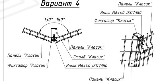
Варианты устройства углов ограждения. Система ограждения "Класик"или "Пром" с фиксатором Класик Изм. Лист № докум. Подп. Дата
