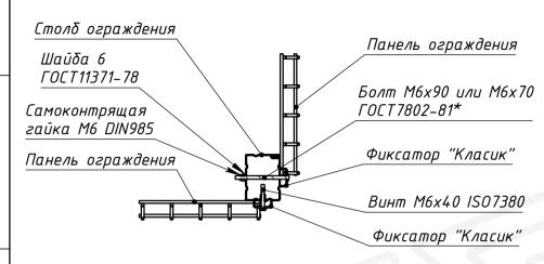
\*- отверстия (Ф 7мм) под болт выполнить по месту установки ограждения
